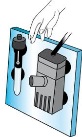
5. En este siguiente paso ya puede instalar el filtro y el calentador, pero sin conectarlo a la red eléctrica. Recomendamos seguir las instrucciones del fabricante sobre los aparatos eléctricos. Para un reparto uniforme del agua atemperada por el calentador, le sugerimos su instalación cerca de la toma de aspiración de agua del filtro.
